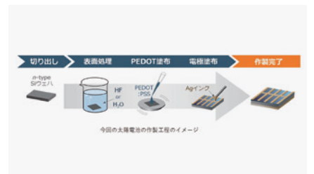
大気中かつ室温での太陽電池の作製を 実現—低コストで簡便に太陽電池の製 造が可能に—
